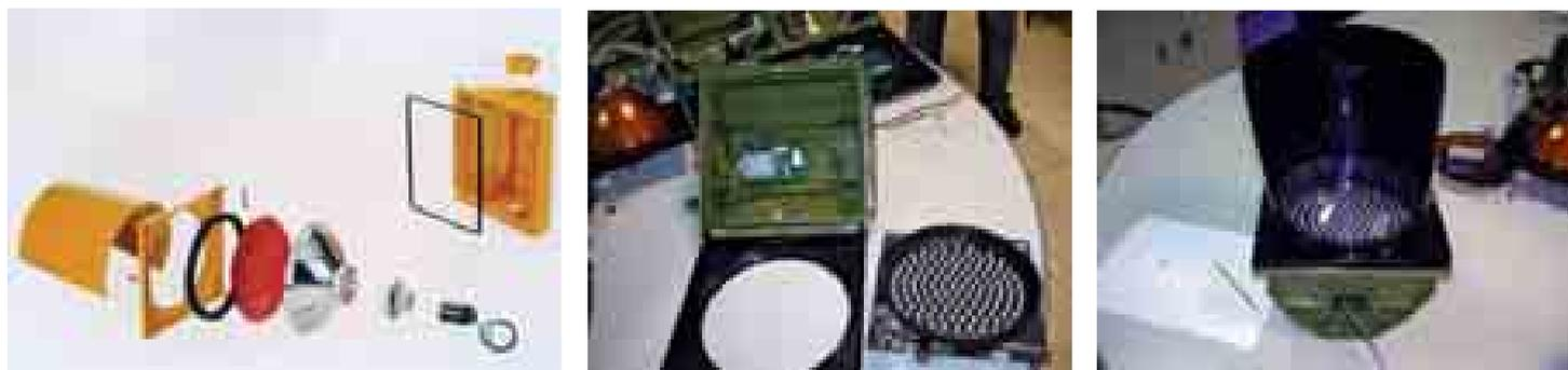
Componentes de un semáforo normal –izquierda- y de un semáforo LED.
